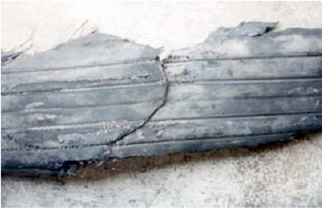
FIG. 6 – Lambeau de pneu du Concorde
